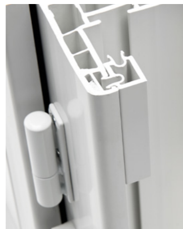
Réducteur 12/16 mm [dormant rénovation PVC avec aile de 40 ou 60 mm monobloc]
