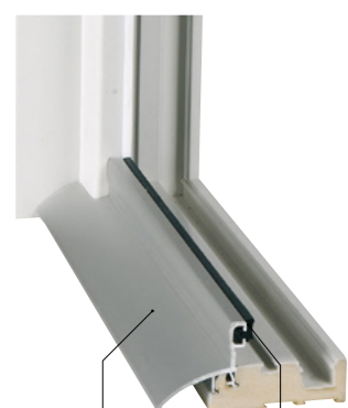
Extérieur L'aluminium assure l'esthétique et la résistance Intérieur Le composite expansé assure le drainage et la rupture thermique
